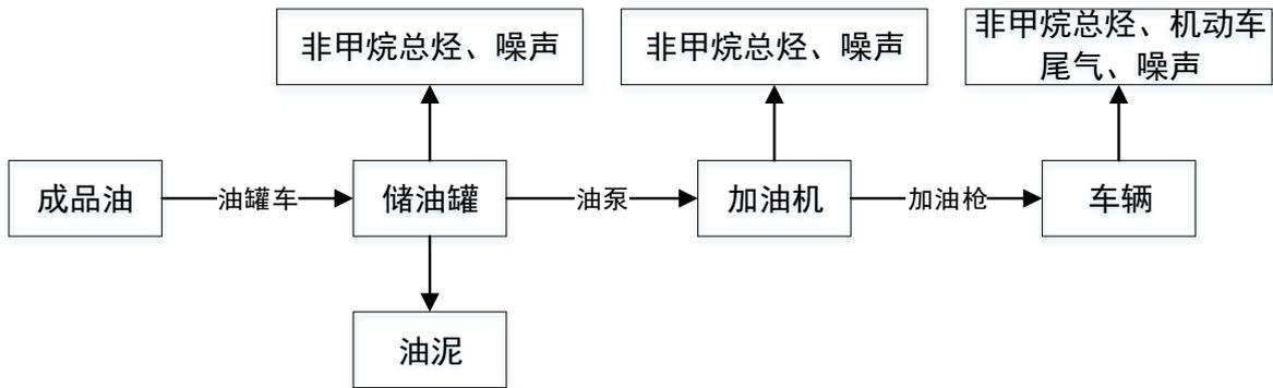
图 2-2 加油站工艺流程及产污环节图
