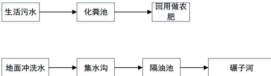
图 3-1 项目污水排放流程图
