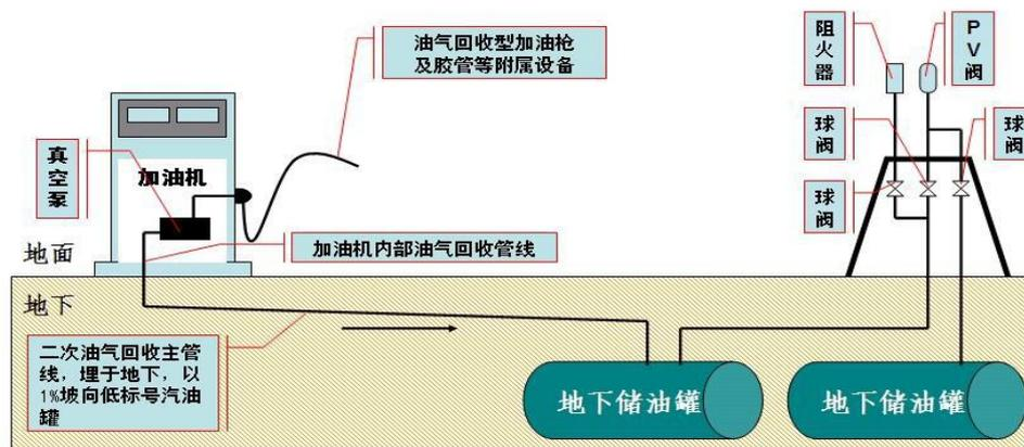
图 3-6 加油区油气回收（二次油气回收）系统基本原理图
