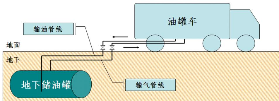
图 3-5 卸油区油气回收（一次油气回收）系统基本原理图
